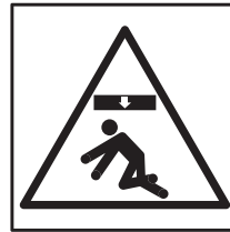
Klämfara - fallande material
